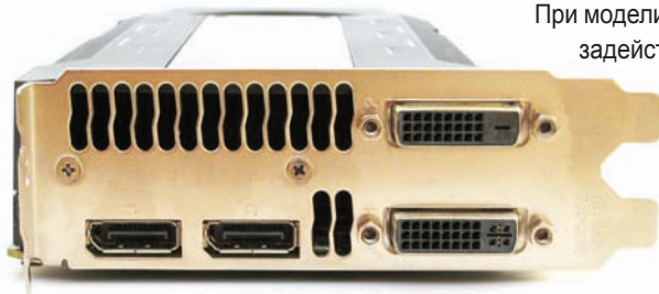
Панель интерфейсов платы Quadro K5000
